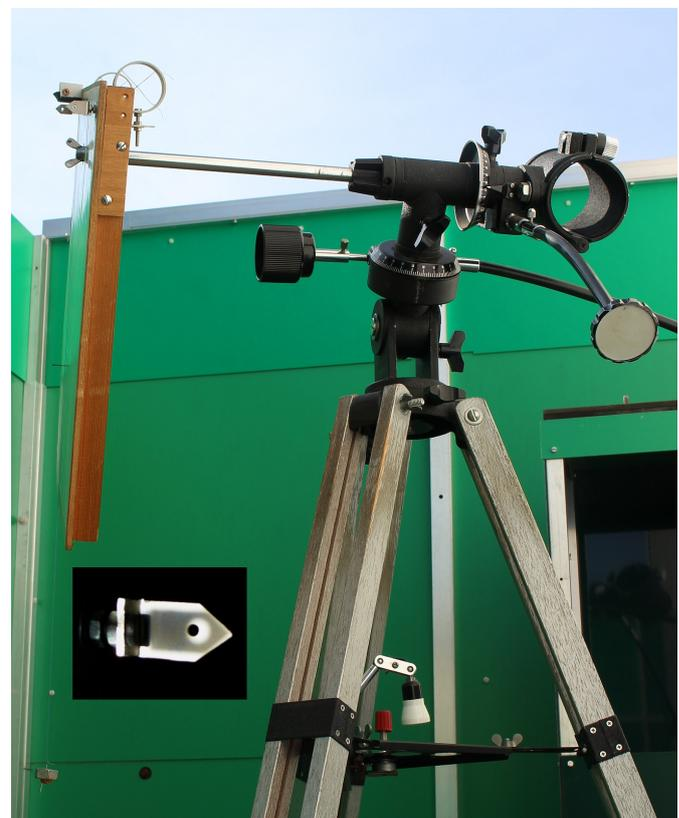
Der Quadrant auf der Fernrohrmontierung. Die Feinbewegung gestattet eine bequeme Ausrichtung des Quadranten und eine exakte Einstellung des Zielobjektes. Anschließend kann der Höhenwert leicht abgelesen werden.
