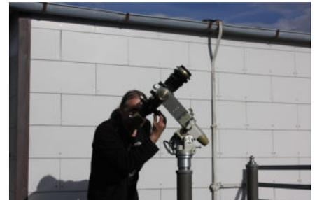
Das neue H $\alpha$ -Sonnenteleskop Coronado 70 / 400 SolarMax III, hier beim ersten Test-Einsatz, ermöglicht eine zusätzliche mobile und dank eines besonders niedrigen Stativs (im Bild noch mit Säule) nun ebenfalls barrierefreie H $\alpha$ -Beobachtung, um etwa auch Protuberanzen sehen zu können. Es steht im Kontrollraum bereit und ist mit Blick auf die weiterhin zunehmende Sonnenaktivität sowie die partielle Sonnenfinsternis am 25. Oktober ein großes zusätzliches Plus auf der Plattform.
