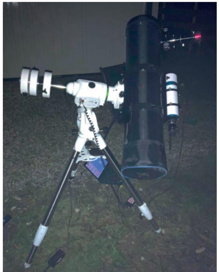
**Abbildung 3:** Dieser 20-cm-Newton wird direkt vor der Sternwarte aufgebaut und hat die Aufgabe, ein Farbbild von Jupiter aufzunehmen.
